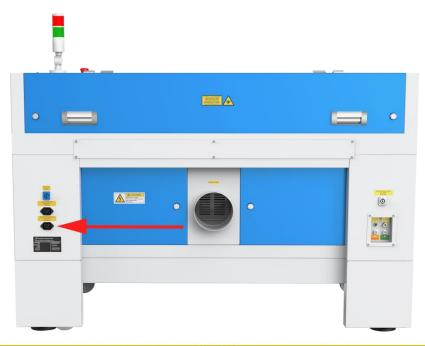
Output: Exhaust fan AC 230V 50/60Hz Output: Exhaust fan AC 115V 50/60Hz
